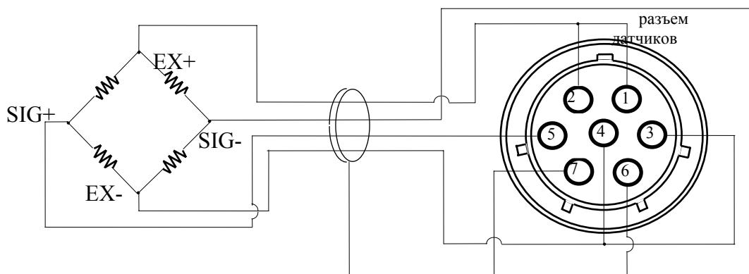
Для проверки тензодатчика отключите питание и проверьте, что напряжение между точками (SIG+, SIG-) такое же, как и при нажатой клавише ON/OFF на передней панели.
